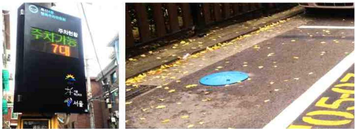
[그림 6] 독산동 행복주차 골목 주차 가능 센서와 현황판 자료 : 과학기술정책연구원(2017), 국내 리빙랩 현황 분석과 발전 방안 연구
