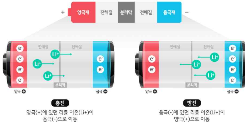
[그림 8] 리튬 이온 배터리의 작동 원리
