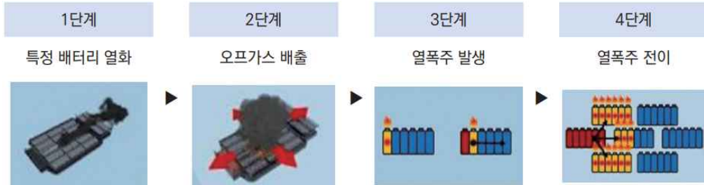
[그림 6] 전기차 배터리팩의 열폭주 단계
