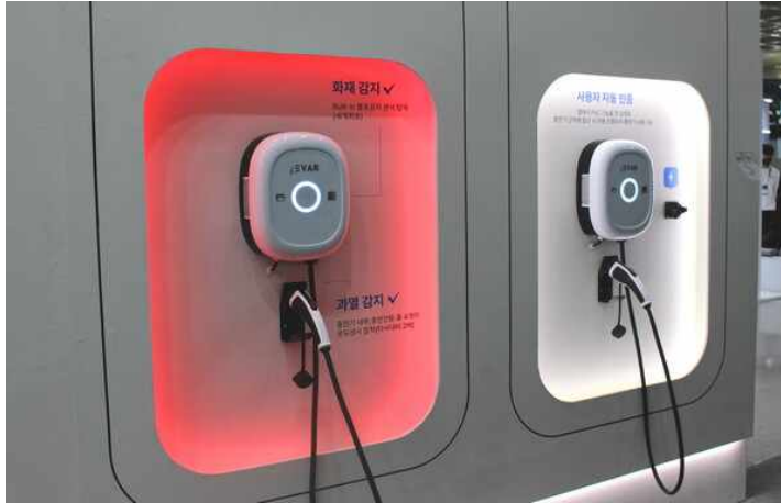
[그림 19] 과열·화재 감지 기능이 탑재된 전기차 충전기 (출처: 전기신문)
