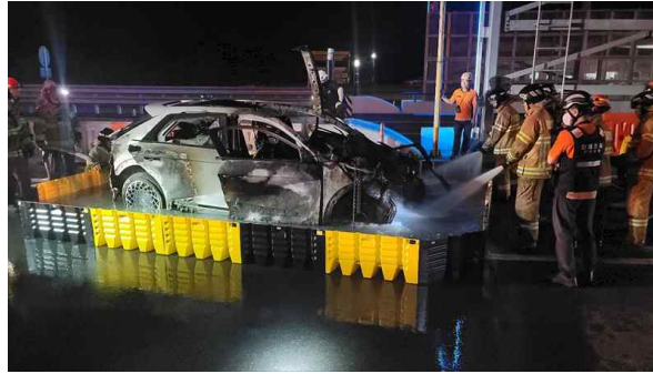
[그림 14] 차량 침수형 진화 시스템
