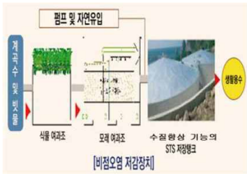
<그림 6.5> 스테인리스 탱크를 이용한 빗물 저장시설 개념도
