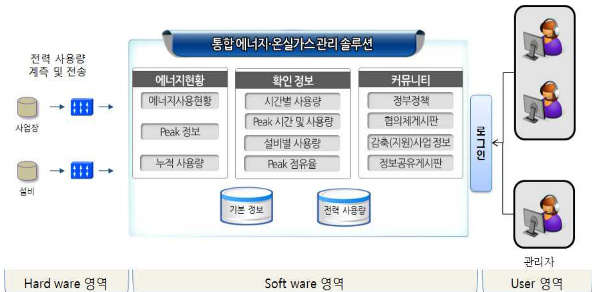
그림 5. 군단위 에너지 관리시스템 구성도
