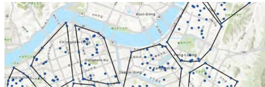
수배송최적화 • 네트워크 최적화 시뮬레이션 활용 • 초기 배송 권역 생성 → 배송 권역 재편성 → 권역별 라우트 실행
