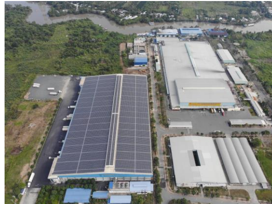
베트남 CJ Gemadep 냉동물류센터 태양광 설치 • 2만5천㎡ 넓이의 지붕에 10,880개의 태양광 모듈 • 매년 7,066MWh의 재생에너지를 생산
