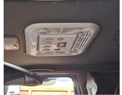
무시동 에어컨 설치 • 차량의 시동을 꺼도 작동하는 냉난방장치 • 냉난방을 위해 공회전을 할 필요 없음
